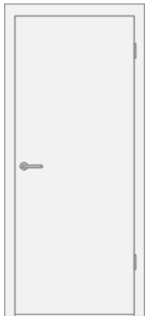
ДПГ EI 30 (60).01.RW... Дверь противопожарная глухая однопольная
